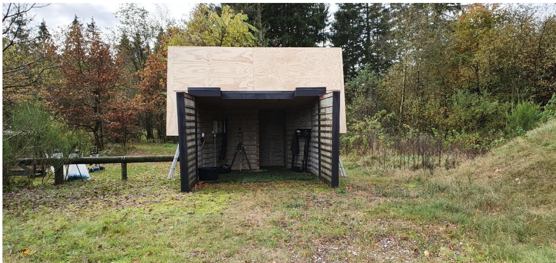
Figur 29. Forsøg med forøget højde og bredde på spidsduehus på Givskud flugtskydebane. Den forøgede højde gav en markant forbedring i retninger modsat skudretningen.
